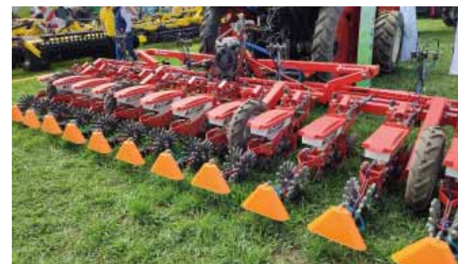
Obr. 9: Secí stroj pro přesný výsev agregovaný s postřikovačem pro páskovou aplikaci kapalin současně při seti; jde o řešení pro aplikaci půdních bakterií na leguminózy nebo k aplikaci herbicidu nad osetý řádek, zbytek plochy je možné plečkovat nebo oset pomocnou plodinou, která je schopna potlačit plevele a sama není herbicidem brzděná v růstu
