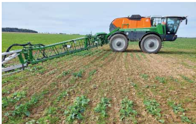
Obr. 1: Postřikovač Amazone Pantera se senzory DAT Ecopatch na ramenech pro monitoring plevelů a cílený zásah přímo v průběhu aplikace herbicidu
