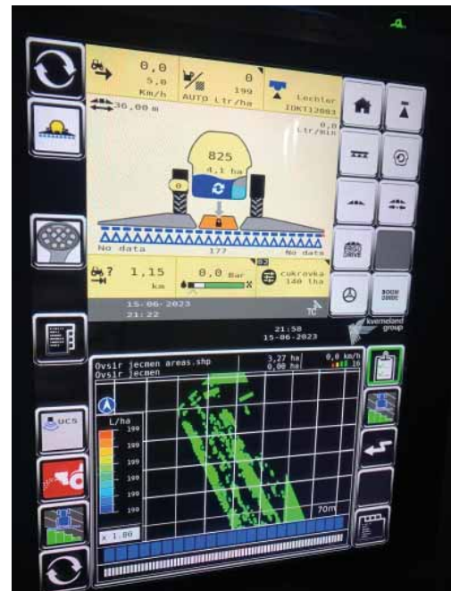
Obr. 8: Záznam z postřikovače při lokalizované aplikaci herbicidu proti ovsu hluchému v jarním ječmeni
