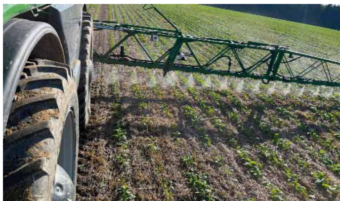
Obr. 3: Postřikovač Amazone Pantera při páskové aplikaci postřiku každou druhou tryskou nad řádky řepky s roztečí 50 cm
