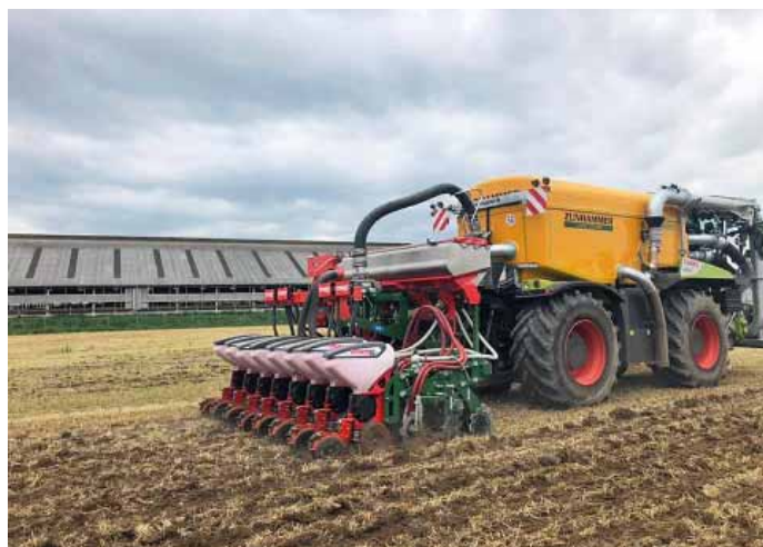
Setí kukuřice do strniště žita v jedné operaci se strip-tillem a aplikací digestátu (ZD Dolní Újezd)
