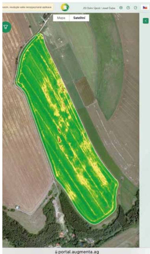
Aplikační mapa pozemku s porostem řepky - plochy poškození jsou jasně definovány, v těchto místech není potřeba hnojit ani aplikovat fungicidy; problematická místa v řepce vymezují snímky ze satelitu a AUG index
