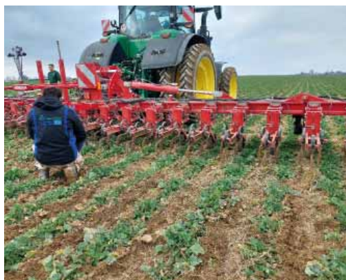
Opticky naváděná plečka Horsch Transformer 12VF umožňuje vynechat plošnou aplikaci herbicidů proti dvouděložným plevelům a podpoří jarní mineralizaci
